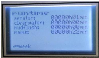
Die Betriebsstunden werden hochgezählt wenn die Steuerung den Belüfter mit dem zugehörigen Ausgang des Drehmotors eingeschaltet hat. Die Laufzeit des Verdichters ergibt sich dann als Summe der Einzelaufzeiten. Die Anzeige erfolgt in Stunden und Minuten.
