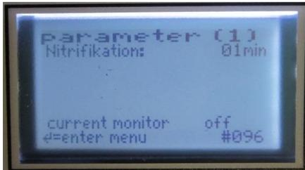
In diesem Menü werden die Parameter für die Nitrifikation und Denitrifikation eingestellt (optional).
