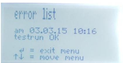
Das Fehlerlogbuch zeigt die letzten 20 Fehlerereignisse mit Datum und Uhrzeit an. Mit den Pfeiltasten wird im Logbuch geblättert, mit der mittleren Taste wird das Menü verlassen.
